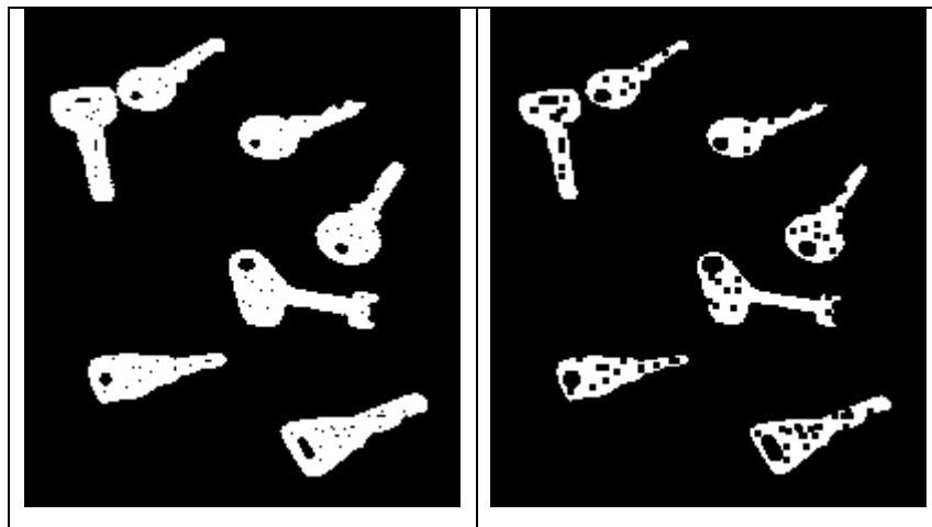
Figura 10: Imatge amb soroll "Pepper" i imatge amb soroll amplificat provocat per l'aplicació d'un "erode"
