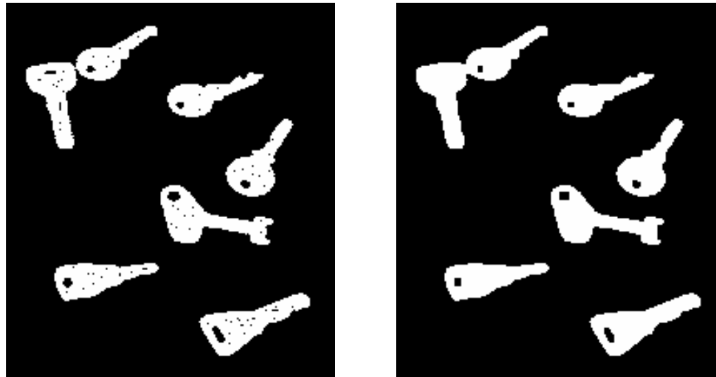
Imagen con ruido "Pepper" y resultado de la aplicación de un "closing"
