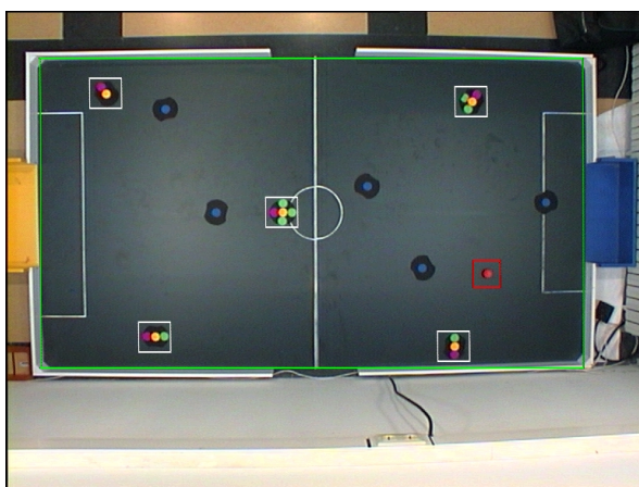
Figura 5 Seguiment dels 5 jugadors i de la pilota per la tarja de processament
