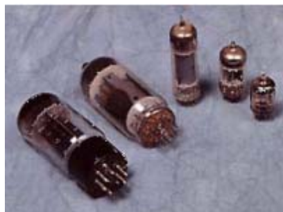
Figura 18.- Válvulas de vacío
